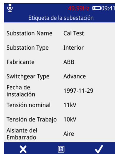
Información sobre la subestación añadida al estudio
