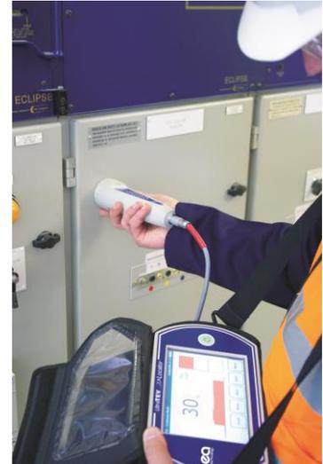
Por supuesto, los instrumentos utilizados para pruebas *en-línea*, deben ser lo suficientemente sensibles y selectivos para permitir la exacta detección de las DP en condiciones de servicio.
