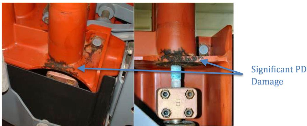
A pesar de este nivel de daño, cuando la humedad relativa cayó alrededor del 40% de HR, la actividad ultrasónica y actividad de PD medida directamente pasó a niveles indetectables. Si la prueba fuera-de-línea o en-línea de este equipo fue hecha en un día de humedad relativa baja, este tipo de daño pasaría inadvertido.
