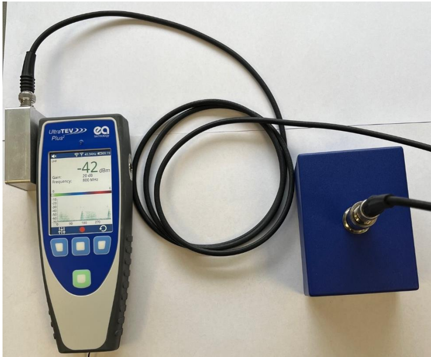
Sensor UTP2-UHF-A2 conectado al UHFR1 mediante un cable coaxial
