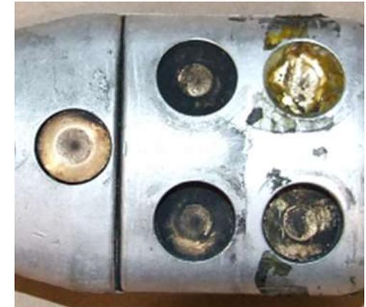
**30 mm de separación en el aislamiento Sólo 1 perno de cizalladura en contacto**
