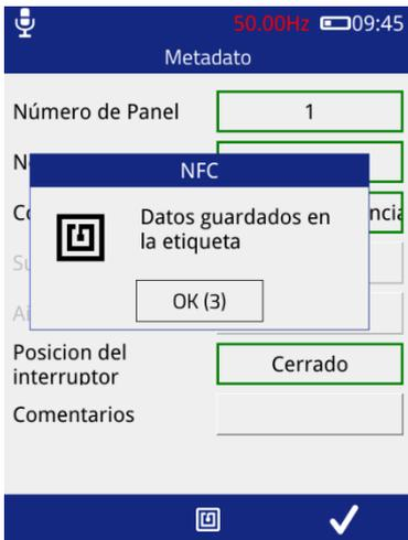
El UTP2 emitirá un pitido para indicar que se ha detectado una etiqueta, seguido de dos pitidos para indicar que la escritura se ha realizado correctamente
