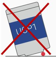
Entrada de polvo entre el cabezal del sensor UCP1 y la superficie.
