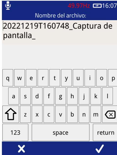
La imagen de la captura de pantalla se puede ver extrayendo la tarjeta SD e insertándola en un PC. Navegue hasta el directorio \data y abra el archivo .png correspondiente. Alternativamente, la captura de pantalla se puede ver usando la interfaz web a través de una conexión USB o Punto de Acceso.
