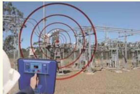
Las nuevas generaciones de instrumentos para evaluar el estado de una planta son cada vez más valiosos y fáciles de usar. Por ejemplo, este nuevo PD Hawk™ puede analizar con seguridad playas de distribución con corriente en busca de problemas de potencia, en solo minutos.
