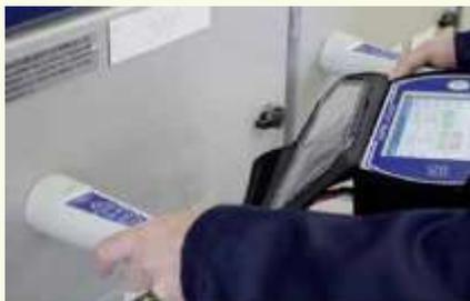
Los instrumentos de doble sonda pueden usar mediciones del tiempo de vuelo para localizar actividad de DP interna con una exactitud de 10cm.
